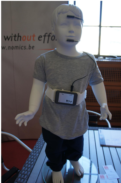
2 magneettianturin välin kasvu paljastaa suuhengittelyn/kuorsauksen
